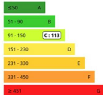
Logement énergivore (kWh EP/m<sup>2</sup> an)
